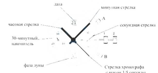
**Установка времени:** Выдвинуть заводную головку в положение 2. Вращая по часовой стрелке, установите требуемое время.
